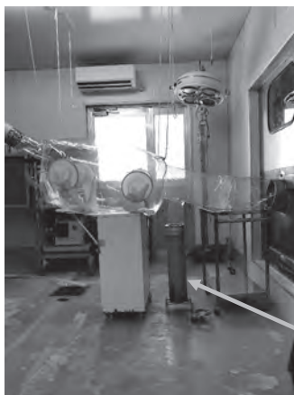
ビニールチャンバー内にフィルターを介して空気を送る送風機と麻酔機 左写真：ジャバラホースをビニールチャンバーと接続しておく。右写真：麻酔機
