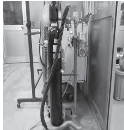
ビニールチャンバー内にフィルターを介して空気を送る送風機と麻酔機 左写真：ジャバラホースをビニールチャンバーと接続しておく。右写真：麻酔機
