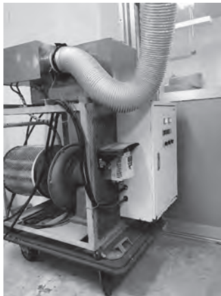
ビニールチャンバー内にフィルターを介して空気を送る送風機と麻酔機 左写真：ジャバラホースをビニールチャンバーと接続しておく。右写真：麻酔機
